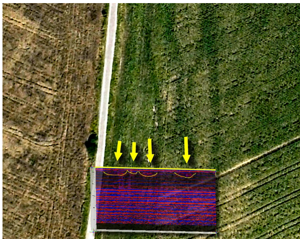
Obr. 88: Radarogram georeferencovaný nad RGB ortofotomapou na pozici měřeného profilu se záznamem rozsahu zahloubení a překreslení průběhu mapovaných podpovrchových forem do mapy. Profil 48 (51m, dosažená max hloubka 7m, rozlišitelnost struktur < 3m). Na profilu č. 48 jsou dobře patrné zahloubené struktury i původní komunikace (0-2m).
