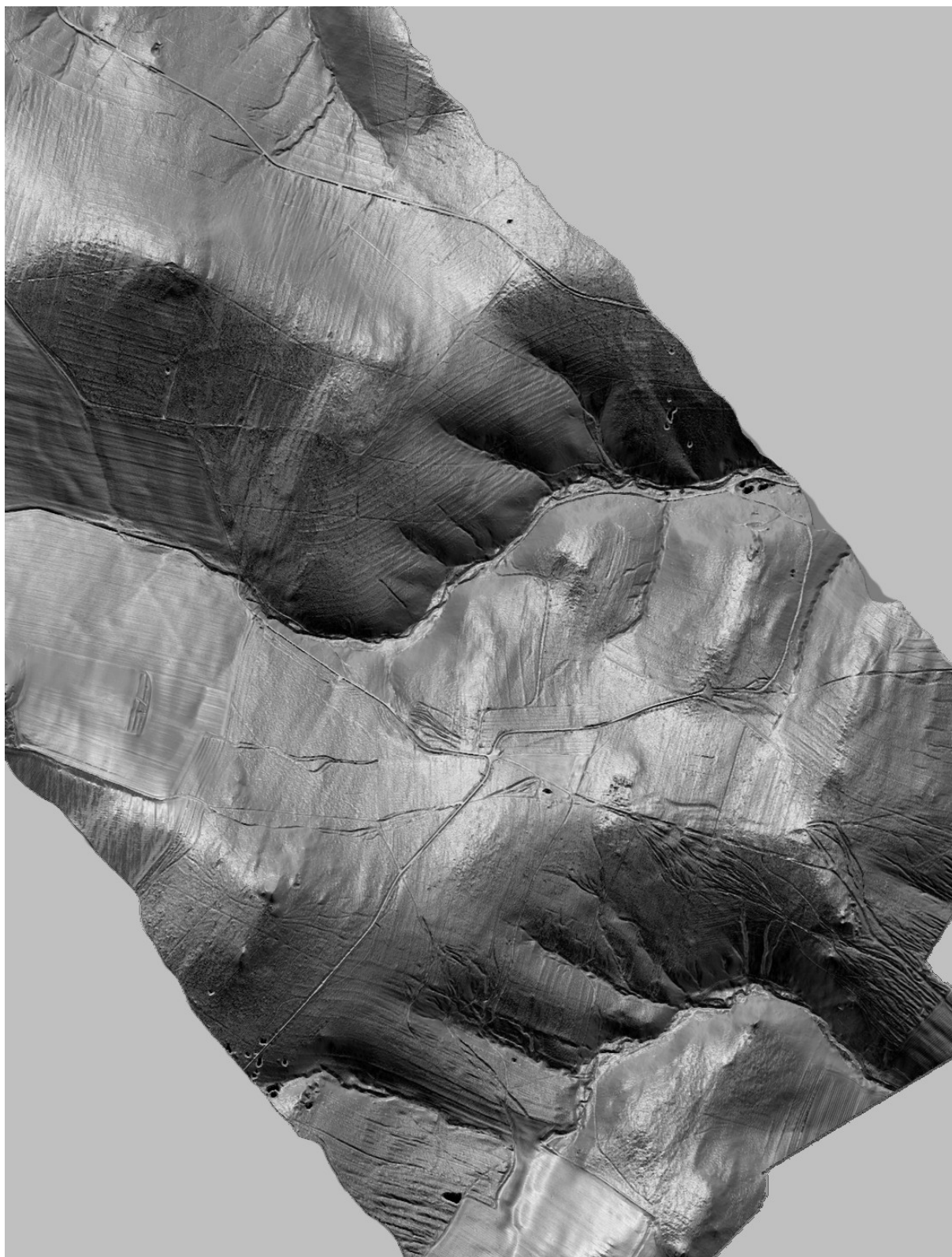
Obr. 69: Syntéza více rastrů. Tento model vznikl kombinací dvou rastrů v poměru sklonitost 35%, orientace 65%. Pro odstranění lokálních nerovností byly oba gridy zprůměrovány (grid sklonitostí maticí 2x2 a grid orientace maticí 5x5). Rastr byl následně ještě upraven v grafickém editoru, kde byla provedena úprava histogramu, odstranění šumu a vyhlazení. Zobrazené území: Starý Ješov, Nové Pole.
