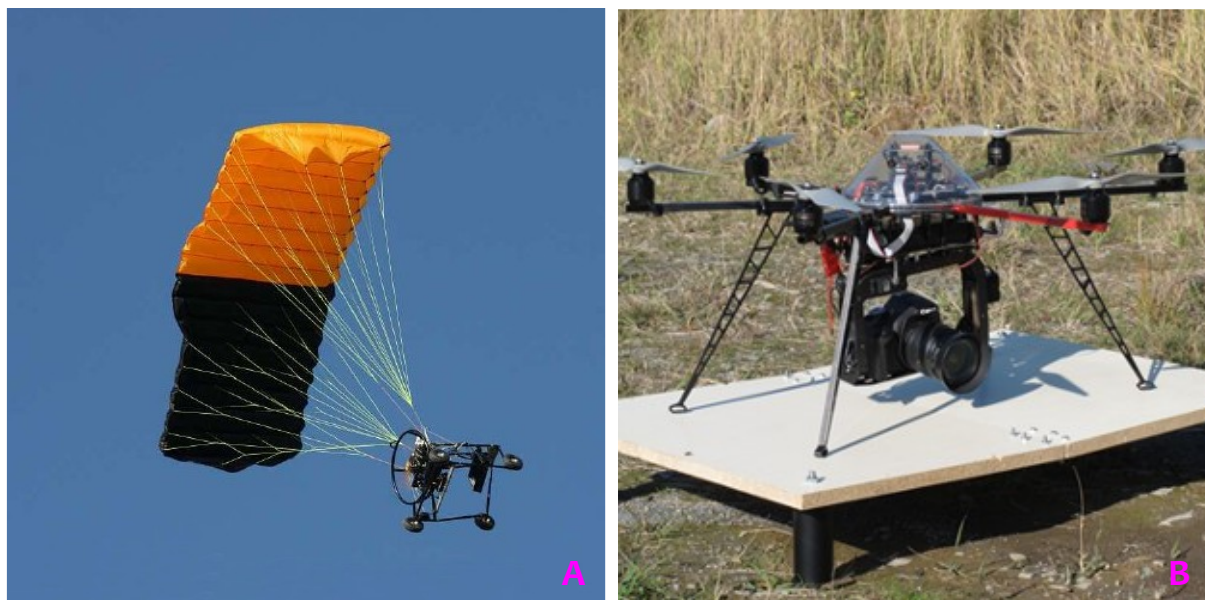
Obr. 40: Modely určené k bezpilotnímu snímkování. A) Model motorového padákového kluzáku Drone Pixy. B) Hexacopter značky HiSystems.
