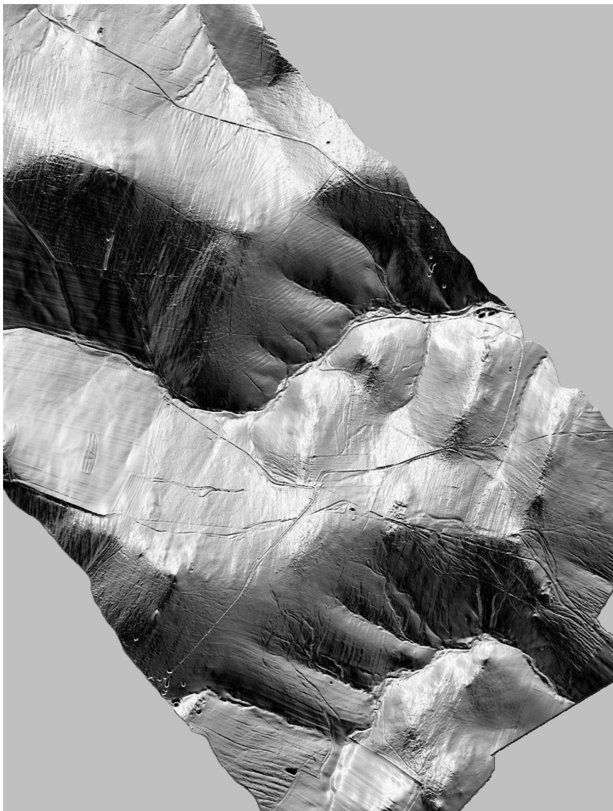
Obr. 68: Orientace vůči světovým stranám (Aspect). Hodnotám azimutu jsou přiřazeny hodnoty odstínů šedi. Přepočet je proveden na dvou samostatných gridech. První grid s orientací svahů 0 až 180^\circ je reklasifikován na interval 255 až 0 . Azimutu 0^\circ tedy odpovídá hodnota 255 (bílá) a azimutu 180^\circ hodnota 0 (černá). Druhý grid s orientací svahů od 180^\circ do 360^\circ je reklasifikován na hodnoty 0 až 255 . Ve výsledku jsou svahy orientované k jihu nejtmavší a svahy orientované k severu naopak nejsvětější. Zobrazené území: Starý Ješov, Nové Pole.
